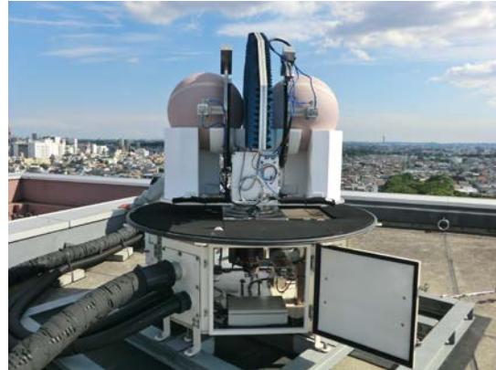
Figure 2: Ku-band radar. (Luneburg lens antennas)
