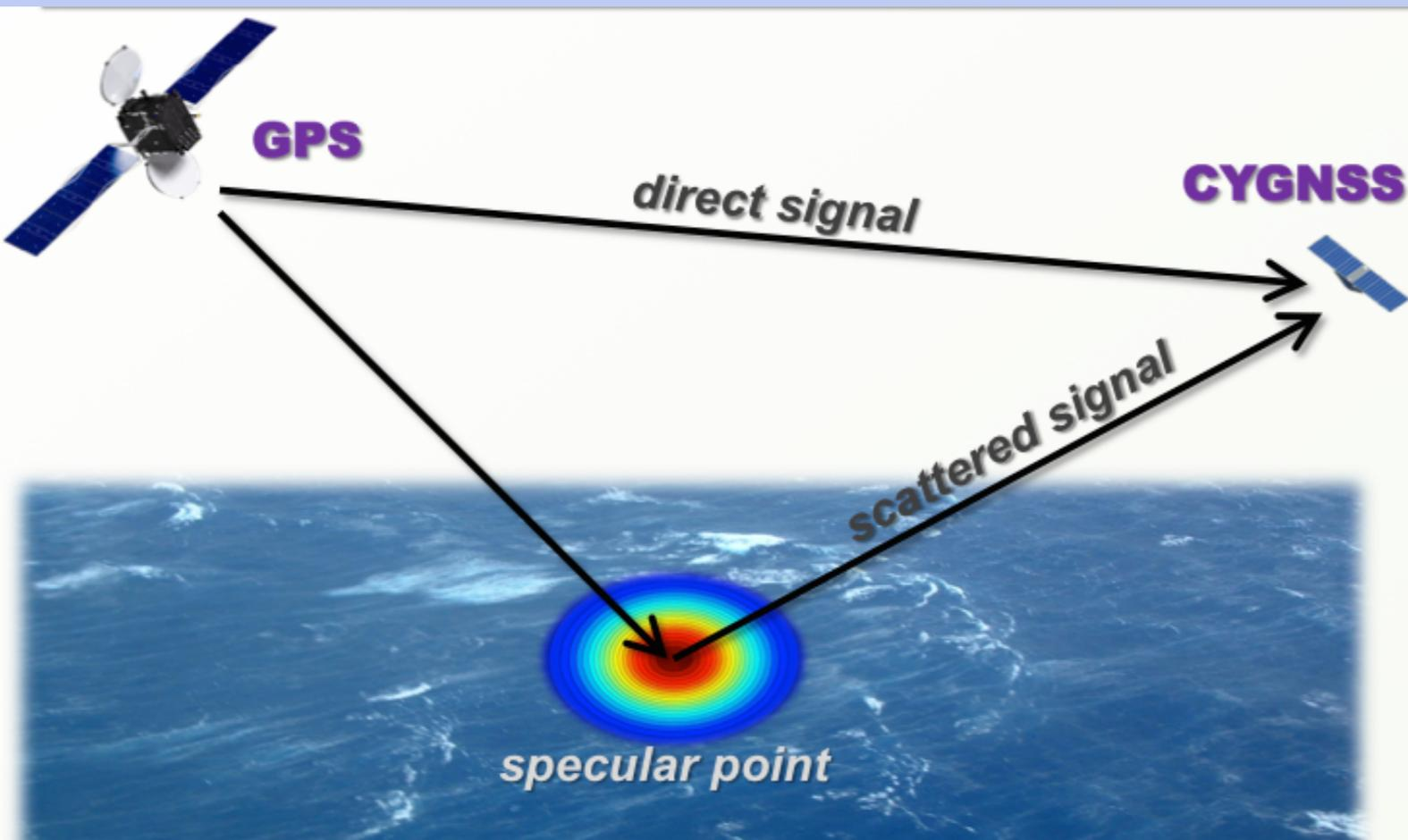
BASIC GEOMETRY OF BI-STATIC QUASI-SPECULAR
