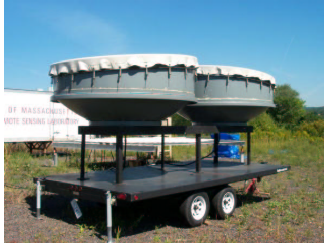
Fig. 2. UMass S-Band FMCW Radar Antennas
